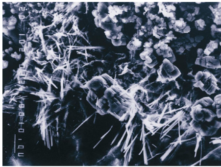
Bild 2 zeigt die Schnittfläche eines Probekörpers 7 Tage nach der Beschichtung mit XYPEX CONCENTRATE. Die beginnende Bildung der fiberförmigen Kristalle ist deutlich erkennbar.
